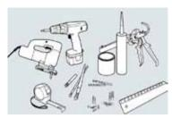
Schraubendreher mit verschiedenen Aufsätzen. Stichsäge mit Holzsägeblatt ( Kreissäge für Profis empfohlen) Kartuschenpistole, Maßband, Lineal, Pinsel, Bürste zum kaschieren der Fugenmasse, 3mm und 8 mm Bits, Dübel und Schrauben, elektrische Nagelpistole, Fugenmasse (Innen- und Außenbereich), Farbe und Altmacherspray ( zum mischen und das Finish
